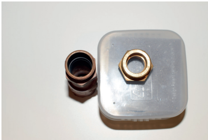
Figur 1. Vänster rördel är ej godkänd. Höger rördel är godkänd.
